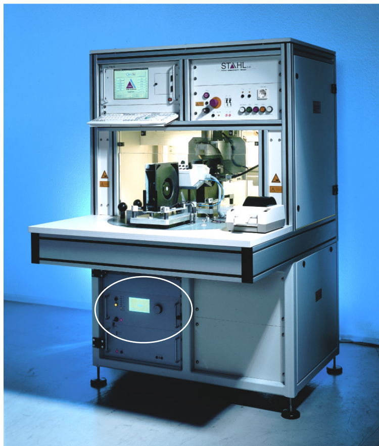
Ein Beispiel aus der Praxis: AC-Quelle integriert in eine PC-gesteuerte Drehtischprüfanlage.
